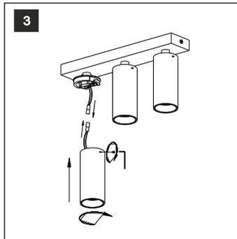
3. Подключите светильник и установите его на крепление, повернув по часовой стрелке и зафиксировав шестигранным винтом.
