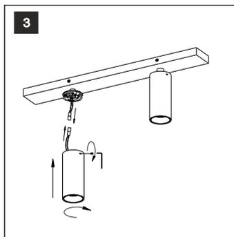
3. Подключите светильники, затем, установите их на крепление и зафиксируйте шестигранными винтами.
