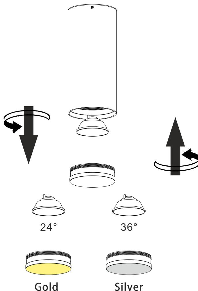
Открутите дефлекторное кольцо и извлеките его из светильника, покачивающими движениями извлеките рефлексор. Сборка производится в обратном порядке.
