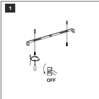
1. Убедитесь, что сетевое напряжение отключено. Открутив два винта по обеим сторонам базы, извлеките монтажную пластину. Разметьте и просверлите в потолке отверстия, используя монтажную пластину как шаблон. Закрепите монтажную пластину на потолке при помощи шурупов.
