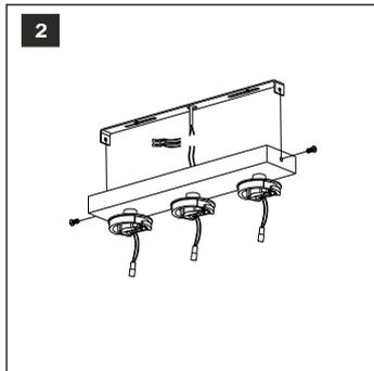
2. Подключите сетевые провода, затем, установите базу на монтажную пластину и зафиксируйте винтами.
