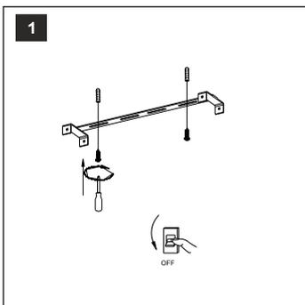
1. Убедитесь, что сетевое напряжение отключено. Открутив четыре винта по обеим сторонам базы, извлеките монтажную пластину. Разметьте и просверлите в потолке отверстия, используя монтажную пластину как шаблон. Закрепите монтажную пластину на потолке при помощи шурупов.
