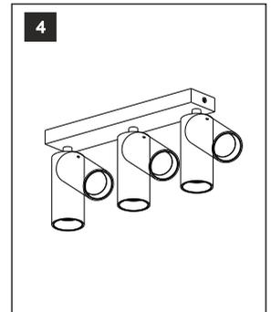
4. Отрегулируйте направление света, наклоня и поворачивая светильники.
