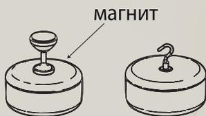
**Данный светильник** – это многофункциональная портативная настольная лампа, легко трансформирующаяся как в подвесную (с помощью крючка), так и в настенную (с помощью магнита), благодаря съемному абажуру и основанию. Также, с помощью специальной насадки, в качестве основания для светильника можно использовать бутылку.
