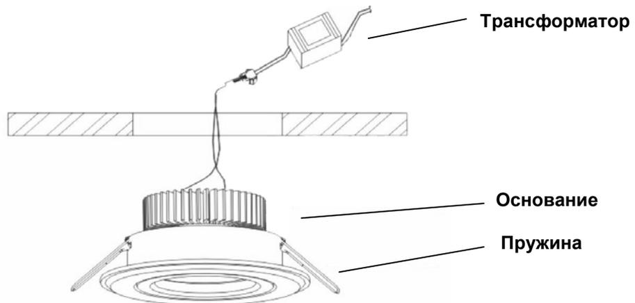
**Схема подключения точечных галогенных светильников 12В**
